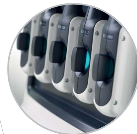
Бесштырьковый коннектор датчика со световым индикатором
