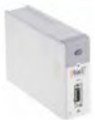
Модуль Masimo RAINBOW Новая технология RAINBOW позволяет измерять концентрацию карбоксигемоглобина (SpCO), метгемоглобина (SpMetHb), содержание общего гемоглобина в крови, а также индекс вариабельности плетизмограммы (PVI).
