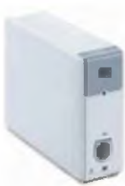
Модуль ИКГ (неинвазивной импедансной кардиографии) Позволяет измерять гемодинамические показатели и параметры сердечного выброса безопасно и легко.
