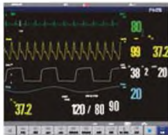
Модуль капнографии На выбор: измерение в боковом потоке, в основном потоке, метод microstream, подходит для интубированных, неинтубированных пациентов, а также для пациентов на искусственной вентиляции легких.
